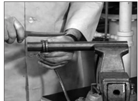
Abb. 2a: Markierung für Ringschnitt
